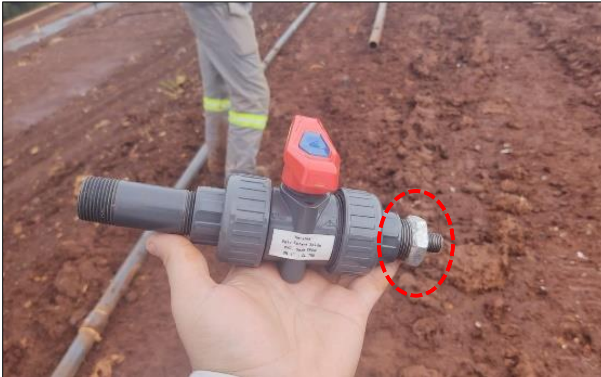
Figura 7 - Válvula esférica para medição de gás, com plug metálico para encaixe do sensor de gás
