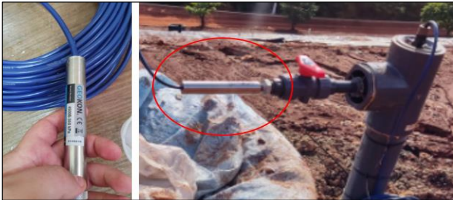
Figura 5 - Sensor de pressão interna (esq.) e Sensor de gás (dir.)
