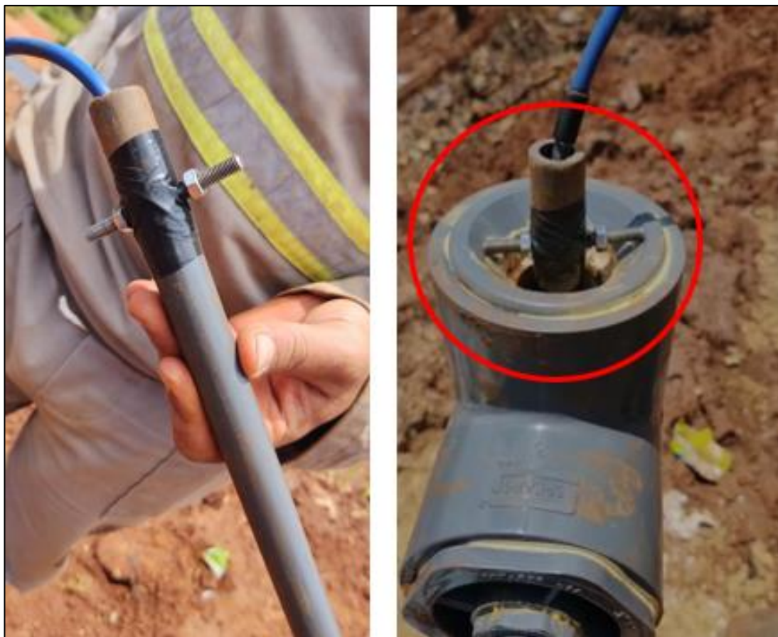
Figura 8 - Fixador sensor elétrico com aço inoxidável (esq.), Tubo encaixado e detalhe de funcionamento do fixador (dir.)
